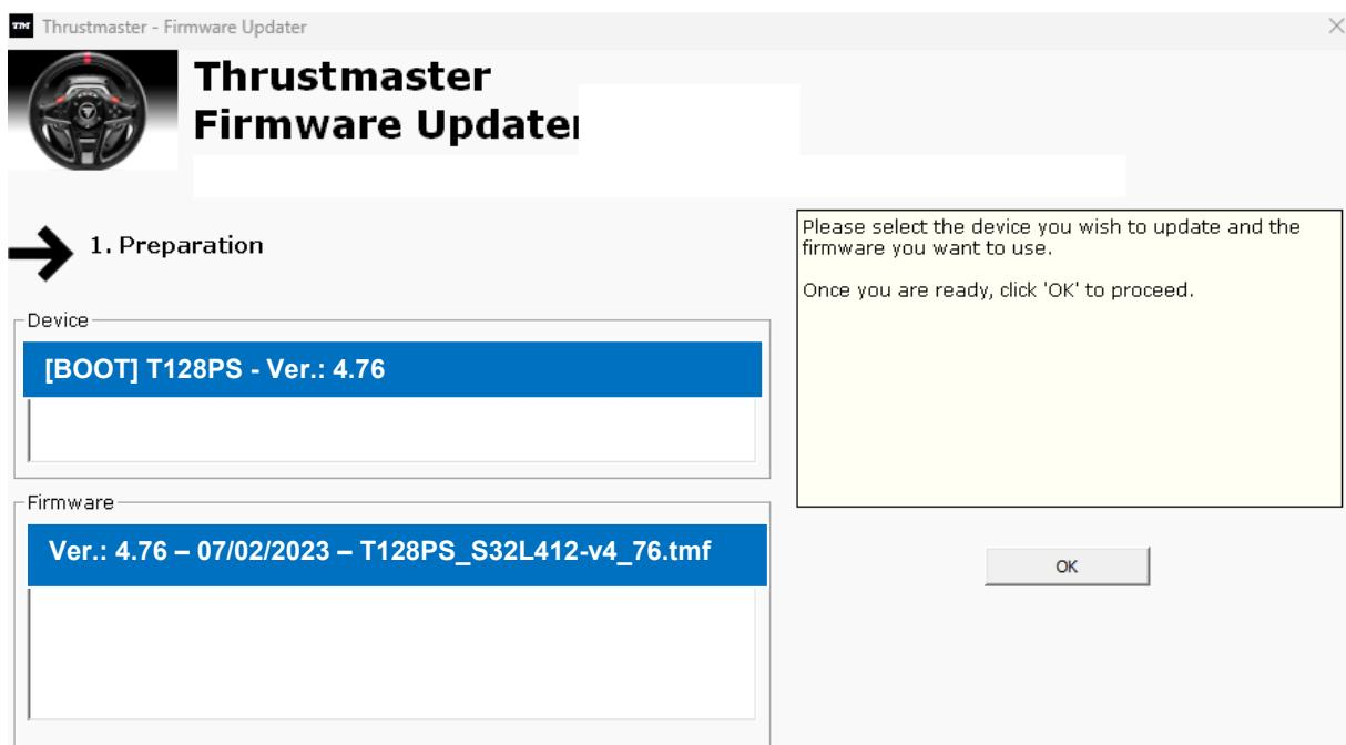
**Opmerking:** Als niets staat vermeld in de secties Device of Firmware, herhaalt u de hele procedure vanaf het begin, maar sluit u deze keer de USB-connector aan op een andere USB-poort op uw computer (of voert u de gehele procedure uit op een andere computer).
