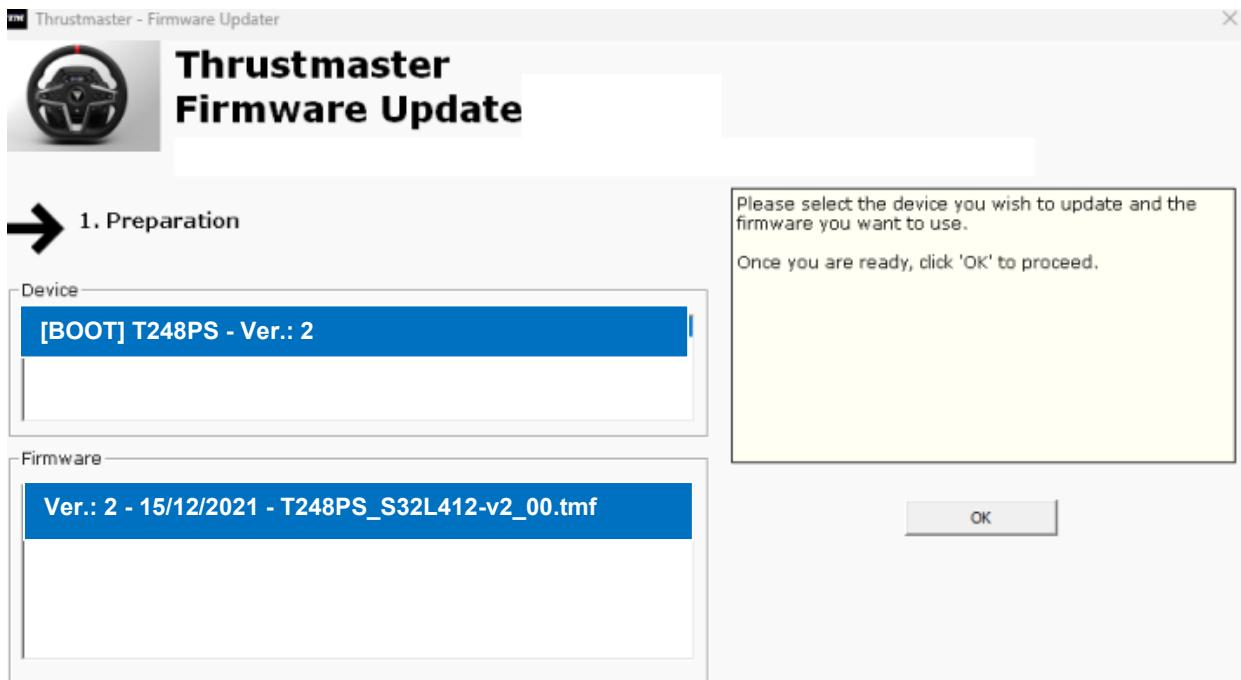
**참고:** Device 또는 Firmware 섹션에 아무것도 표시되지 않는 경우 USB 커넥터를 PC 의 다른 USB 포트에 연결한 후 전체 과정을 처음부터 반복하시기 바랍니다(또는 다른 PC 를 사용하여 이 절차를 수행하십시오).
