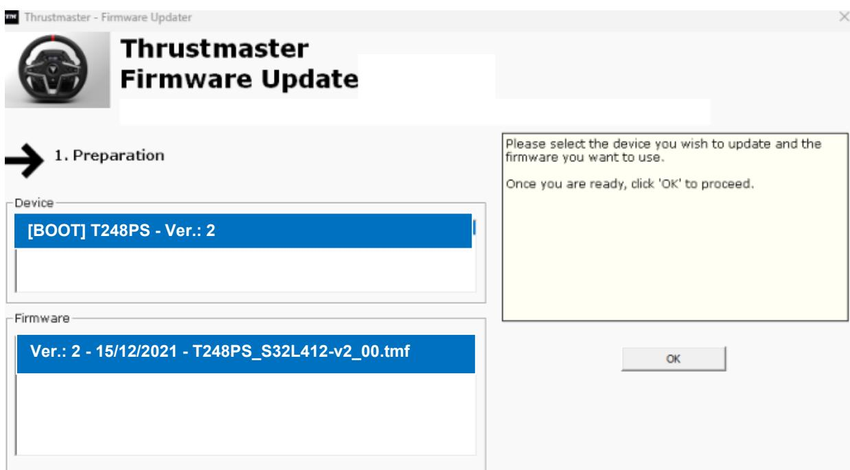
**Hinweis:** Wenn in den Abschnitten Device oder Firmware nichts angezeigt wird, wiederholen Sie den gesamten Vorgang von Anfang an – aber schließen Sie diesmal den USB-Stecker an einen anderen USB-Anschluss Ihres Computers an (oder führen Sie den Vorgang an einem anderen Computer durch).
