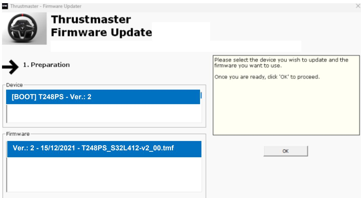
**Nota:** qualora non dovesse comparire nulla nelle sezioni Device o Firmware, ripeti da capo l'intera procedura; ma questa volta collegando il connettore USB ad un'altra porta USB del tuo computer (o eseguendo la procedura su un altro computer).
