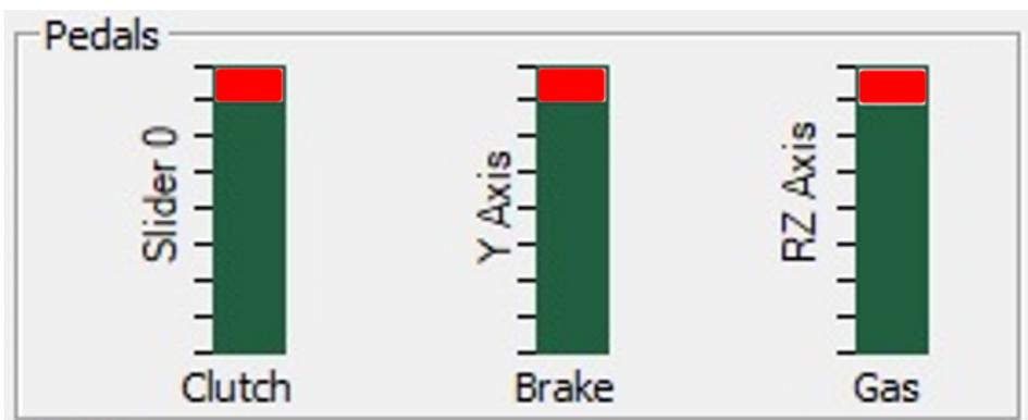
Damit das Pedalset wieder richtig funktioniert (und die 100 %-Werte erreicht), müssen Sie den Modus der Basis manuell auf den Typ **T2PM-T3PA-T3PM** umstellen.
