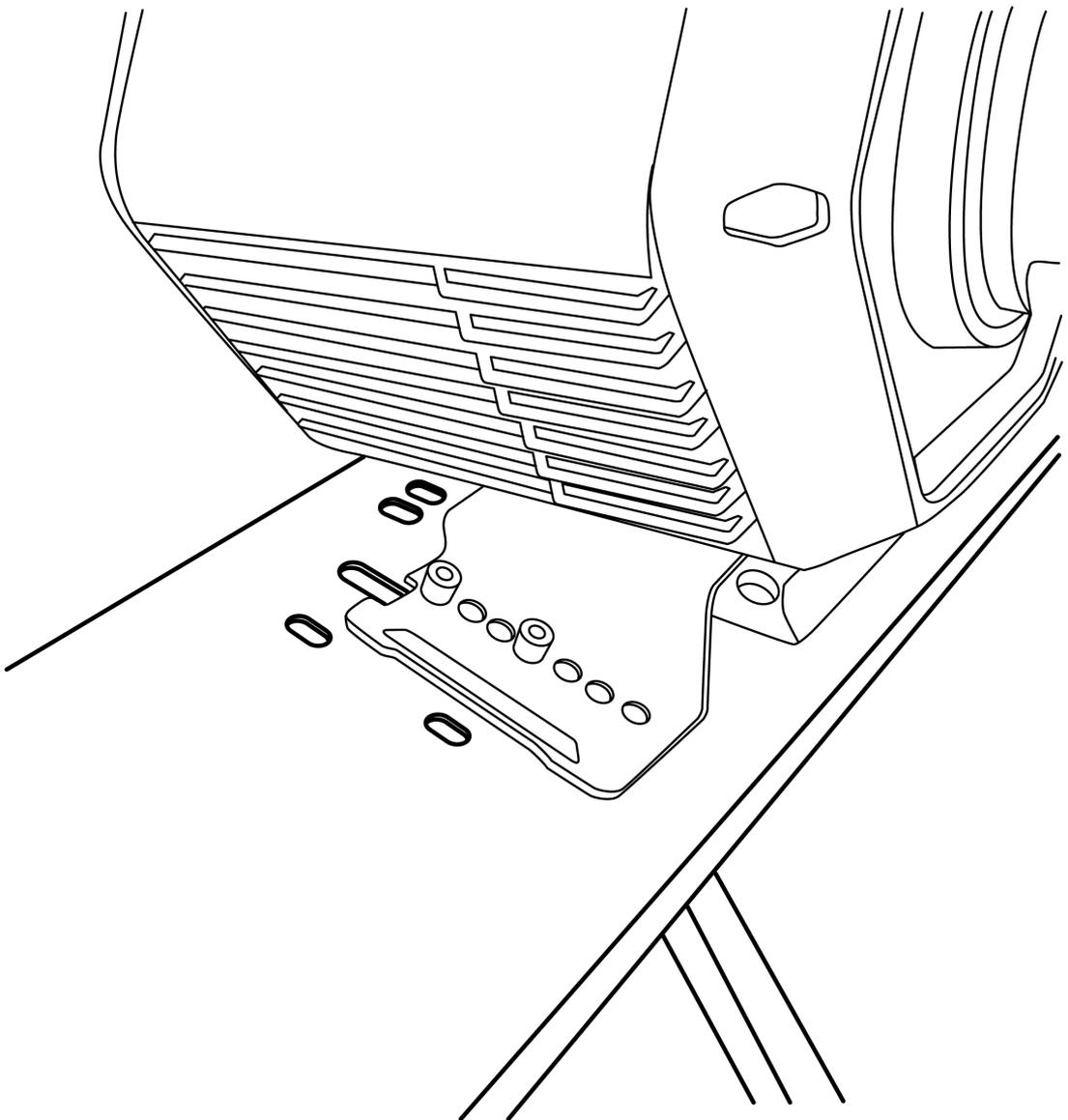
Befestigen Sie die Basis mit diesen Schrauben, die im Lieferumfang des Desk Mounting Kit enthalten sind, an der Ablage des Cockpits. Je nach Cockpit können die Schrauben in drei Varianten verwendet werden.
