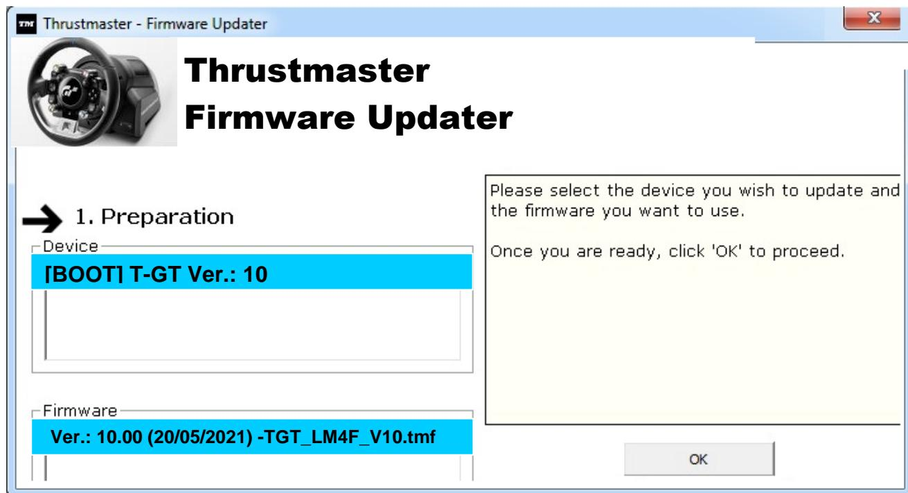
注記:[Device] および [Firmware] フィールドに何も表示されない場合は、ステアリングホイールの USB コネクターを PC の別の USB ポートに接続して、インストールを最初からやり直してください（または、別の PC 上でインストール手順を実行してみてください）。
