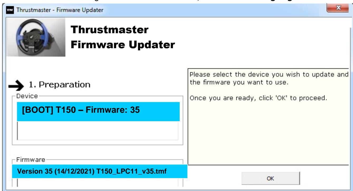
**Anmerkung:** Falls im Geräte- oder Firmware-Fenster nichts angezeigt wird, führen Sie die Installationsprozedur erneut von Anfang an durch und schließen den USB-Stecker des Rennlenkers an einen anderen USB-Port an Ihrem Computer an (oder versuchen die Prozedur an einem anderen PC auszuführen).
