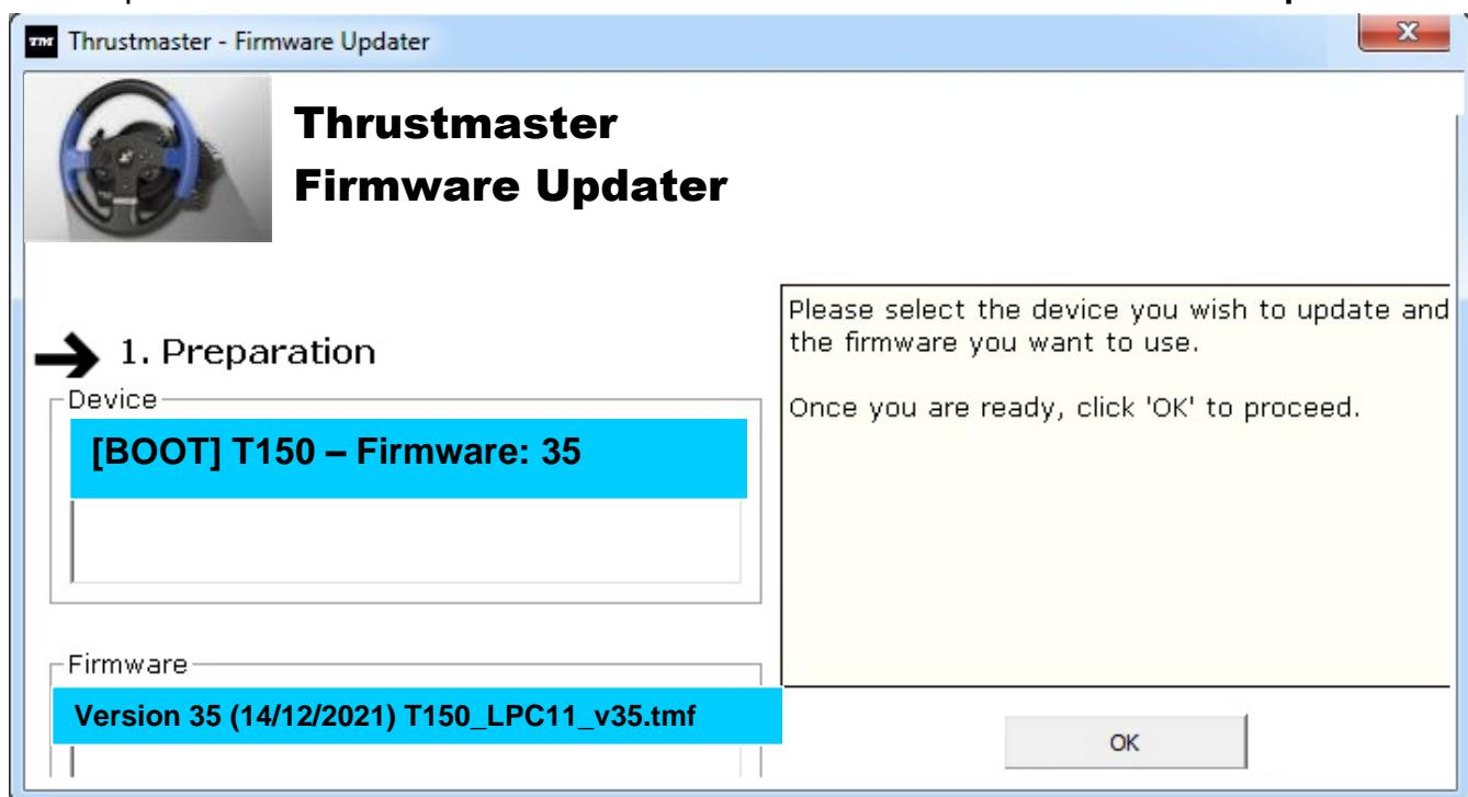
***Nota: se i campi Periferica o Firmware dovessero essere vuoti, ti preghiamo di ripetere daccapo la procedura di installazione, collegando il connettore USB del volante a un'altra porta del PC (oppure eseguendo la procedura su un altro PC).***
