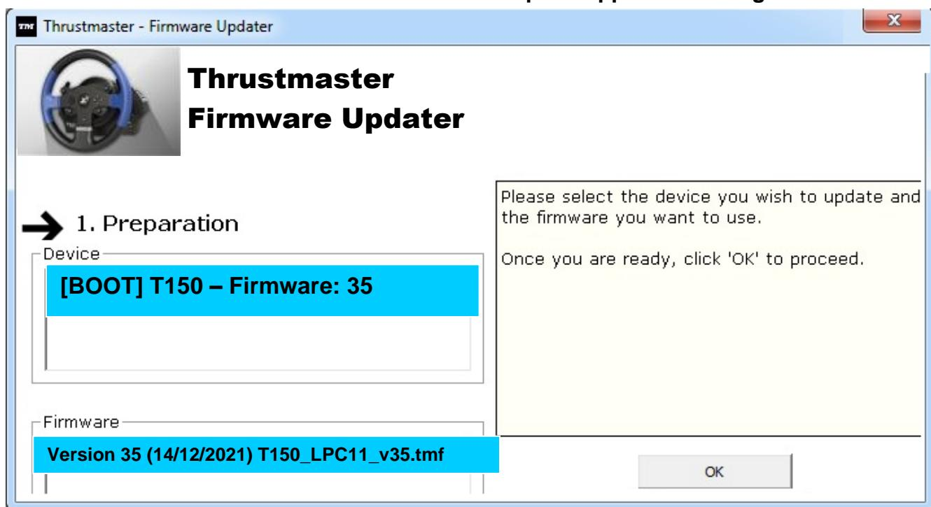
**Opmerking:** als er niets wordt getoond in het veld Device of het veld Firmware, herhaal dan de installatieprocedure vanaf het begin, sluit de USB-stekker van het racestuur aan op een andere USB-poort van de pc, of probeer de procedure op een andere pc uit te voeren.
