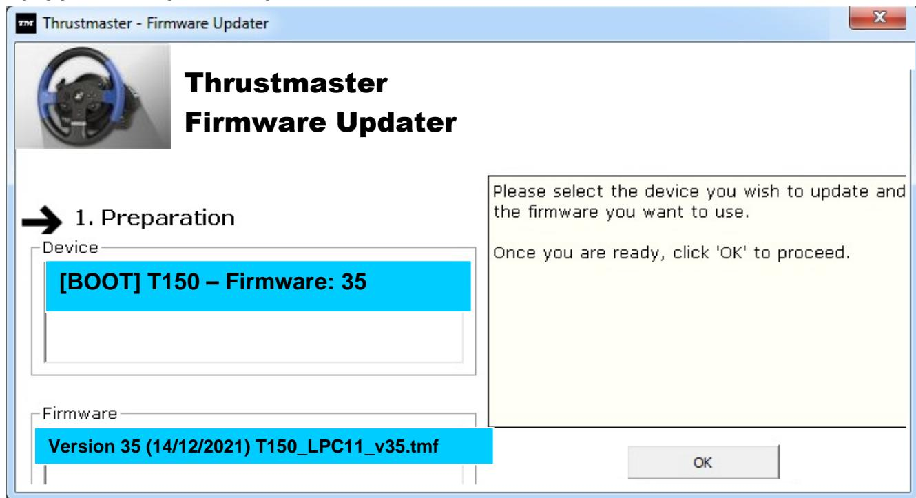
**Σημείωση:** Εάν δεν εμφανιστεί τίποτα στα πεδία **Συσκευή** ή **Υλικολογισμικό**, επαναλάβετε τη διαδικασία εγκατάστασης από την αρχή, συνδέοντας το βύσμα USB της τιμονιέρας σε μια άλλη θύρα USB στο PC (ή δοκιμάστε να εκτελέσετε τη διαδικασία σε άλλο PC).
