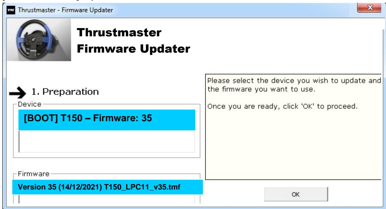
**Примечание: Если в полях «Устройство» или «Прошивка» ничего не отображается, повторите процедуру установки с начала, подключив USB-кабель к другому USB-порту ПК (или запустите установку на другом ПК).**
