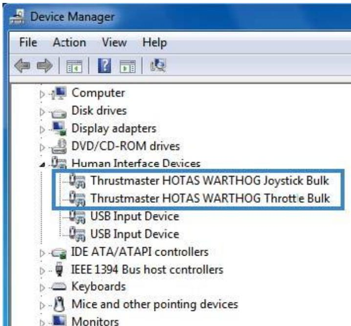
Der Joystick und Gashebel werden nicht mehr im **Gamecontroller** aufgeführt: Dies ist **normal**.
