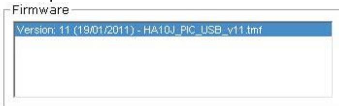
**Nota:** Si no apareciese nada en los campos **Device** o **Firmware**, repite el procedimiento de instalación desde el principio, conectando el dispositivo a otro puerto USB del PC (o prueba a ejecutar el procedimiento en otro PC).
